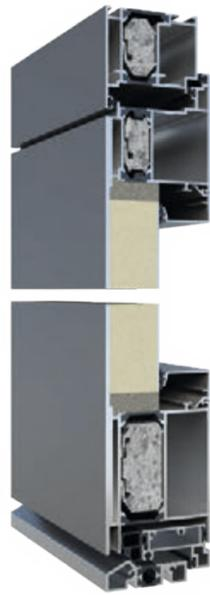
Le système KO 80 HD est notre profilé de base, disponible en ouverture intérieure et extérieure selon vos besoins. Le panneau peut être en feuillure, recouvrant l'ouvrant extérieur et recouvrant extérieur et intérieur. La mousse ISOPOR dans les profilés et les 3 joints d'isolation garantissent une bonne isolation thermique. Ce profilé peut aussi être cintré (arc et plein cintre).
