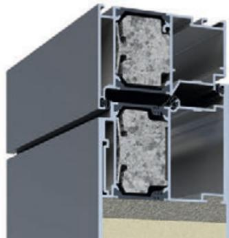
III. panneau recouvrant l'ouvrant intérieur et extérieur
