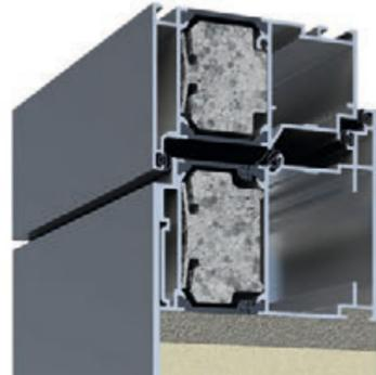
III. panneau recouvrant l'ouvrant intérieur et extérieur
