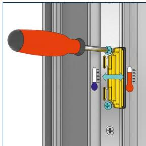
Das Fallengegenstück kann nach Lösen der Kreuzschlitzschrauben im 1 mm Raster verstellt werden. Anschliessend die Kreuzschlitzschrauben wieder anziehen.
