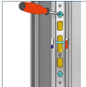
Danach kann die Schließtasche mit einem 4er Inbus durch Drehen der Stellschrauben nach links und rechts bewegt werden. Anschliessend die Kreuzschlitzschraube wieder anziehen.
